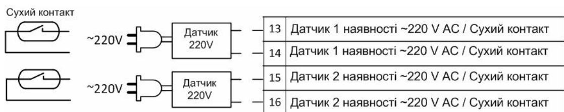
Рисунок 18. Схема підключення датчиків наявності 220В або датчиків типу «сухий контакт» (Connector 20-pin)
