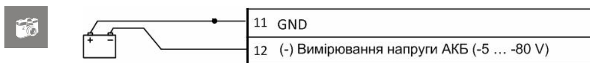
Рисунок 16. Загальна схема підключення акумуляторної батареї до датчика DC (Connector 20-pin)
